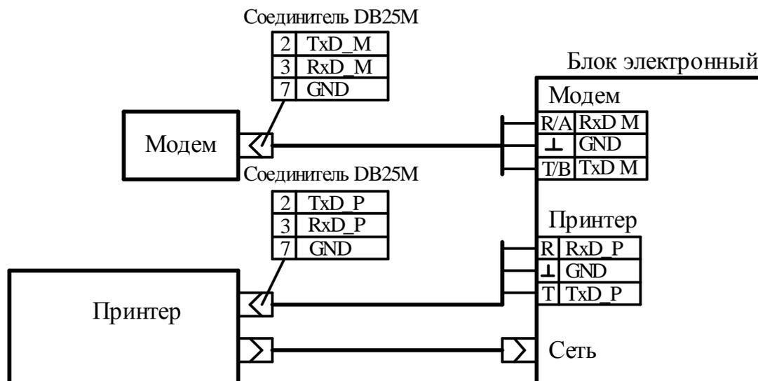
**ПОДКЛЮЧЕНИЕ ПРИНТЕРА И МОДЕМА К КЛЕММНОЙ КОРОБКЕ ЭЛЕКТРОННОГО БЛОКА\***
