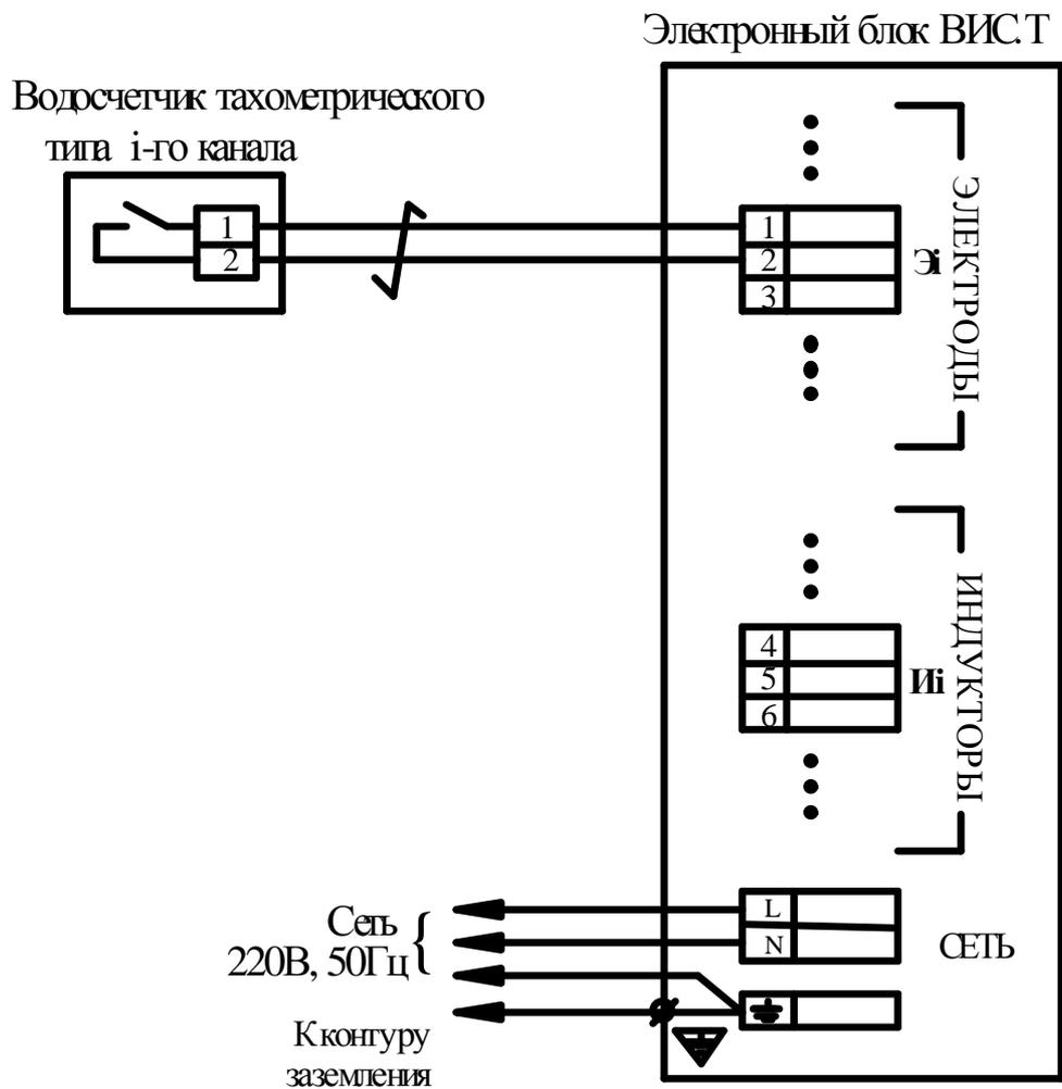
ПОДКЛЮЧЕНИЕ ВОДОСЧЕТЧИКОВ ТИПА ВСГ (ВСТ)
