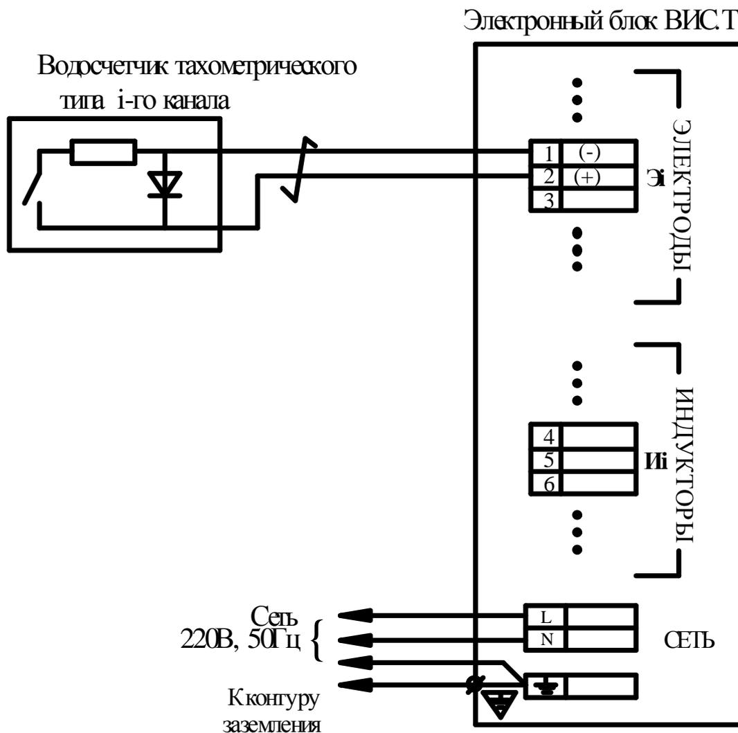
ПОДКЛЮЧЕНИЕ ВОДОСЧЕТЧИКОВ ТИПА МТ
