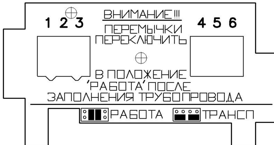
Рис.7 Вид клеммной коробки первичного преобразователя расхода в исполнении Н
