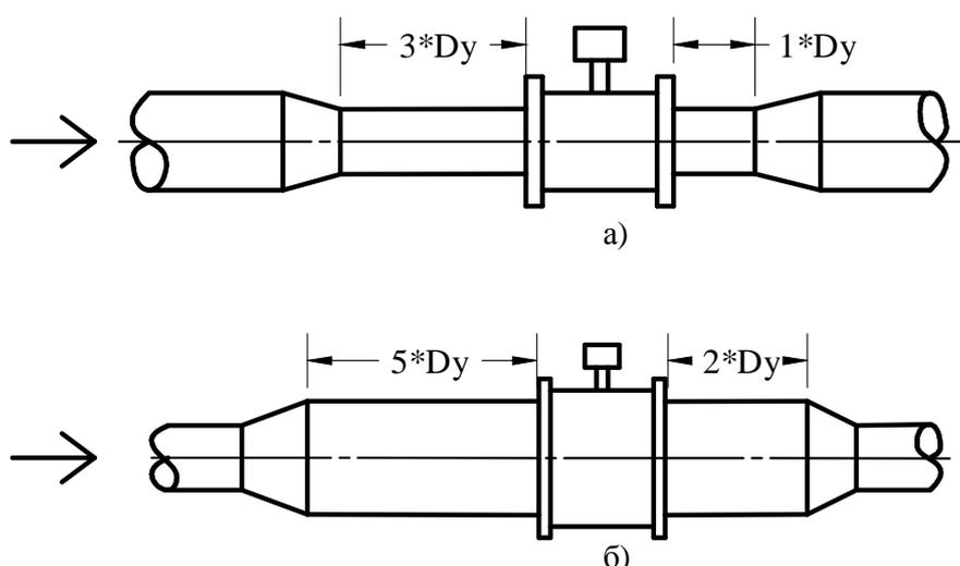
**Рис. 5. Установка ППР на трубопроводах с большим и меньшим диаметрами.**
