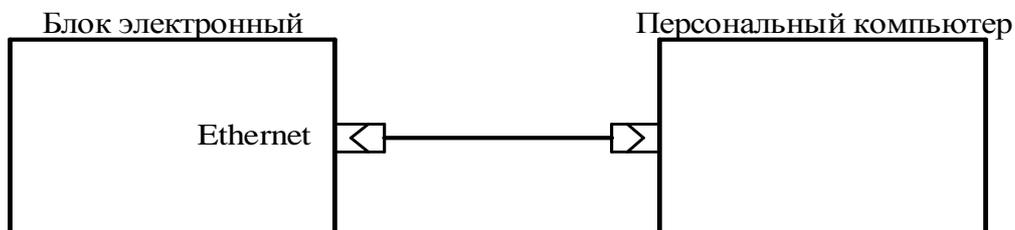
**ПОДКЛЮЧЕНИЕ ТЕПЛОСЧЕТЧИКА К ПЕРСОНАЛЬНОМУ КОМПЬЮТЕРУ (ETHERNET)**
