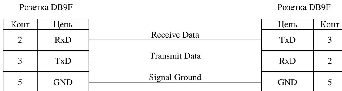
**Рис.1 Кабель нуль-модемный**
