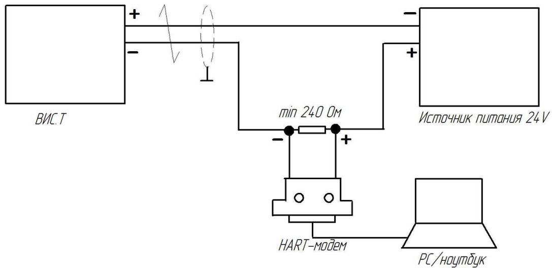
**ПОДКЛЮЧЕНИЕ К ТЕПЛОСЧЕТЧИКУ ЧЕРЕЗ HART**
