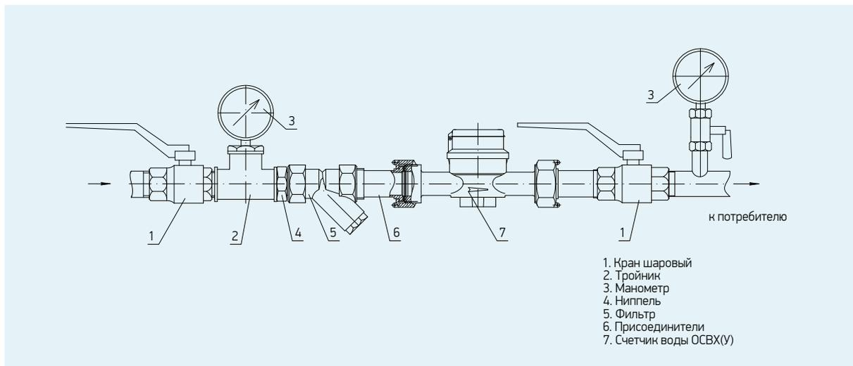
Счетчик не должен подвергаться перегрузкам механическими напряжениями под воздействием трубопроводов и арматуры. При необходимости счетчик может быть смонтирован на подставке или кронштейне.
