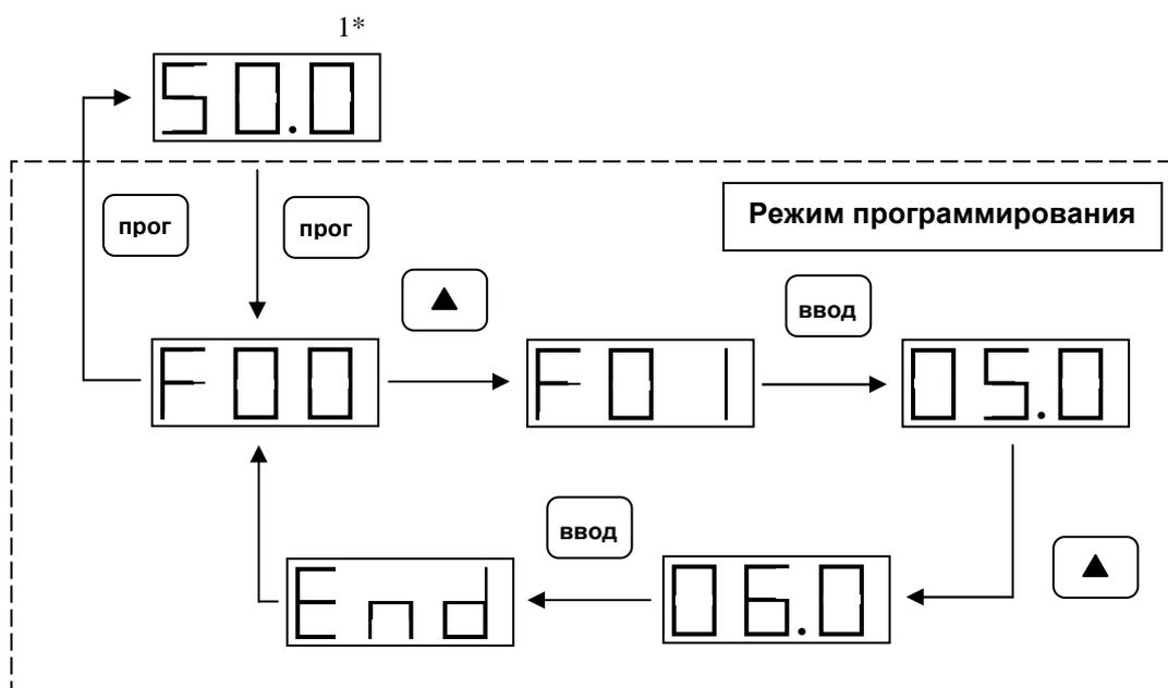
\*1 При останове отображается задание частоты (мигающая индикация).
