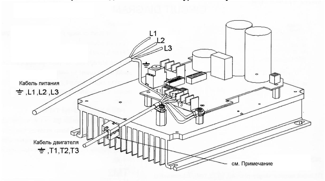
**Примечание.** Для снижения уровня излучаемых электромагнитных помех, кабель двигателя необходимо пропустить через фильтр за пределами корпуса прибора, как показано на рисунке. Детали фильтра (феррит, скоба и винт крепления кабеля) находятся в упаковочной коробке. Длина кабеля двигателя не должна превышать 5 м.
