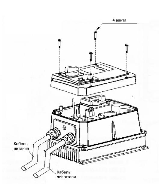
**Способ монтажа при необходимости снижения уровня излучаемых помех**
