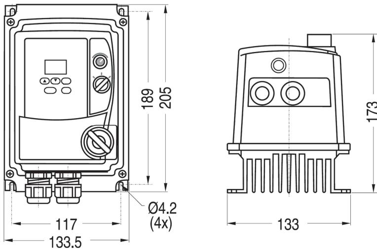
Типоразмер 4: S2L-IP65, S3L-IP65, 001H-IP65, 002H-IP65, 003H-IP65
