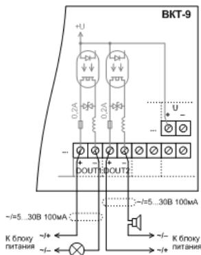
В вычислителе без модуля питания напряжение в цепи «+U» отсутствует, и НЕ ДЕЙСТВУЮТ дискретные выходы.
