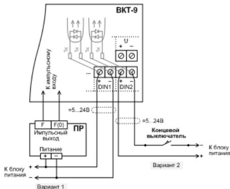
Для питания внешней цепи по варианту 2 допускается использовать выход **U** вычислителя с модулем питания.
