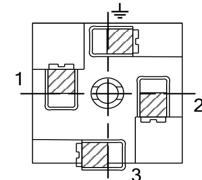
Расположение контактов на розетке разъема со стороны винтового закрепления проводников (Разъем в соответствии DIN 43650C серии GDM с 4 контактами).
