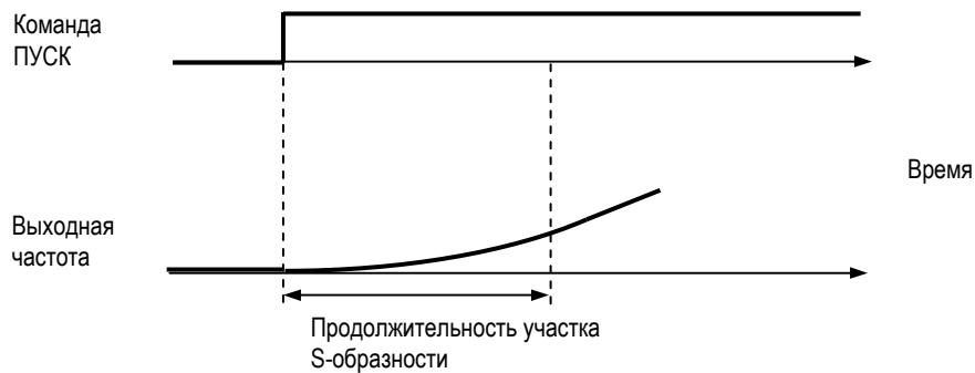
Временная диаграмма ниже иллюстрирует работу в двух направлениях и плавный останов:
