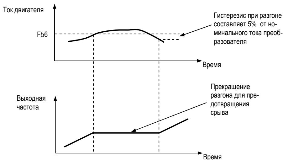
В зоне постоянной выходной мощности (выходная частота больше частоты при максимальном выходном напряжении F11) уровень ограничения тока автоматически снижается по приведенной ниже зависимости:
