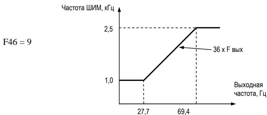
Заводские установки F46 в зависимости от мощности преобразователя
