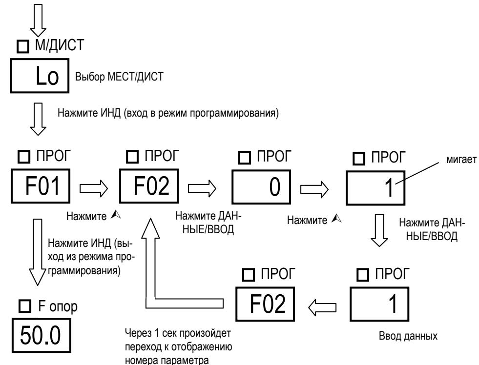
Ниже приведен пример настройки режима работы: необходима работа привода на частоте 40 Гц (задается кнопками с пульта управления), время разгона 20 сек, время торможения 15 сек
