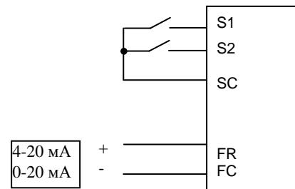
Коэффициент (F41) и сдвиг (F42) аналогового задания частоты может быть установлен как при использовании токового, так и потенциального сигнала управления.
