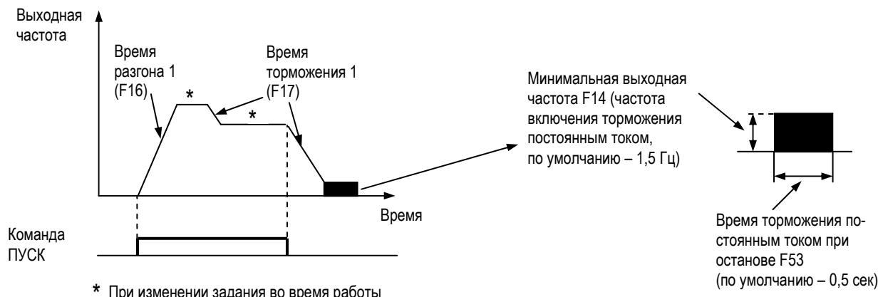
При отключении сигнала ПУСК двигатель замедляется в соответствии со временем торможения 1, и непосредственно перед остановом включается торможение постоянным током. Торможение постоянным током включается также при снижении значения задания ниже минимальной частоты при наличии сигнала ПУСК. Если время торможения мало, или велика инерционность нагрузки, может произойти отключение по перенапряжению. В этом случае необходимо увеличить время торможения или установить тормозной резистор.
