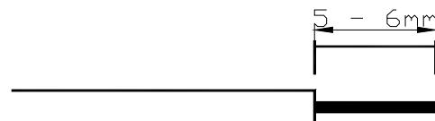
Оголенный участок провода должен иметь длину 5 - 6 мм
