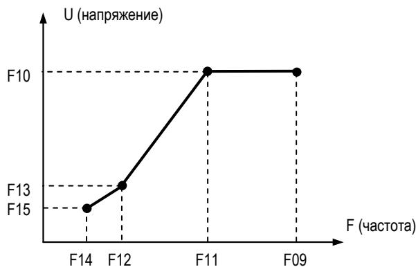
Увеличение напряжения приводит к увеличению момента двигателя, однако излишнее увеличение может стать причиной перевозбуждения двигателя и выхода преобразователя из строя, а также перегрева и вибрации двигателя, поэтому увеличивайте напряжение постепенно и следите за ростом тока двигателя.
