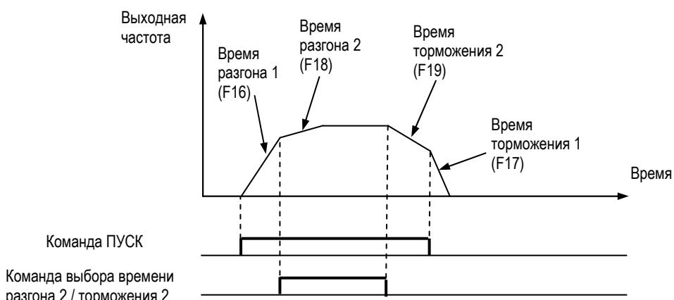
Выберите для одного из многофункциональных входов функцию переключения времен разгона / торможения (F36-F39=11). Теперь сигналом на этом входе можно переключать значения времен разгона / торможения.
