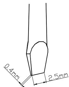
Вставьте провод в нижнюю часть клеммы и затяните его отверткой.
