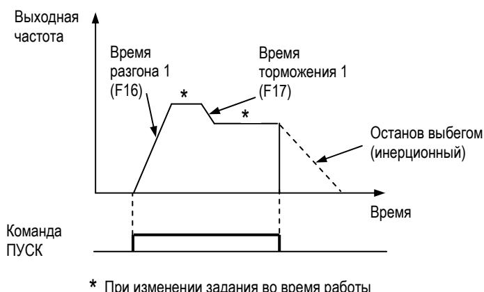
При отключении сигнала ПУСК двигатель останавливается выбегом.
