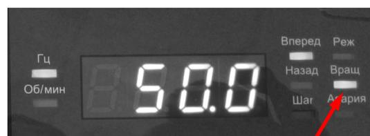
Для останова двигателя необходимо нажать кнопку СТОП на пульте. При этом команда останова двигателя передается в частотный преобразователь, двигатель начинает останавливаться. После завершения останова двигателя индикатор «Вращ» на пульте гаснет.
