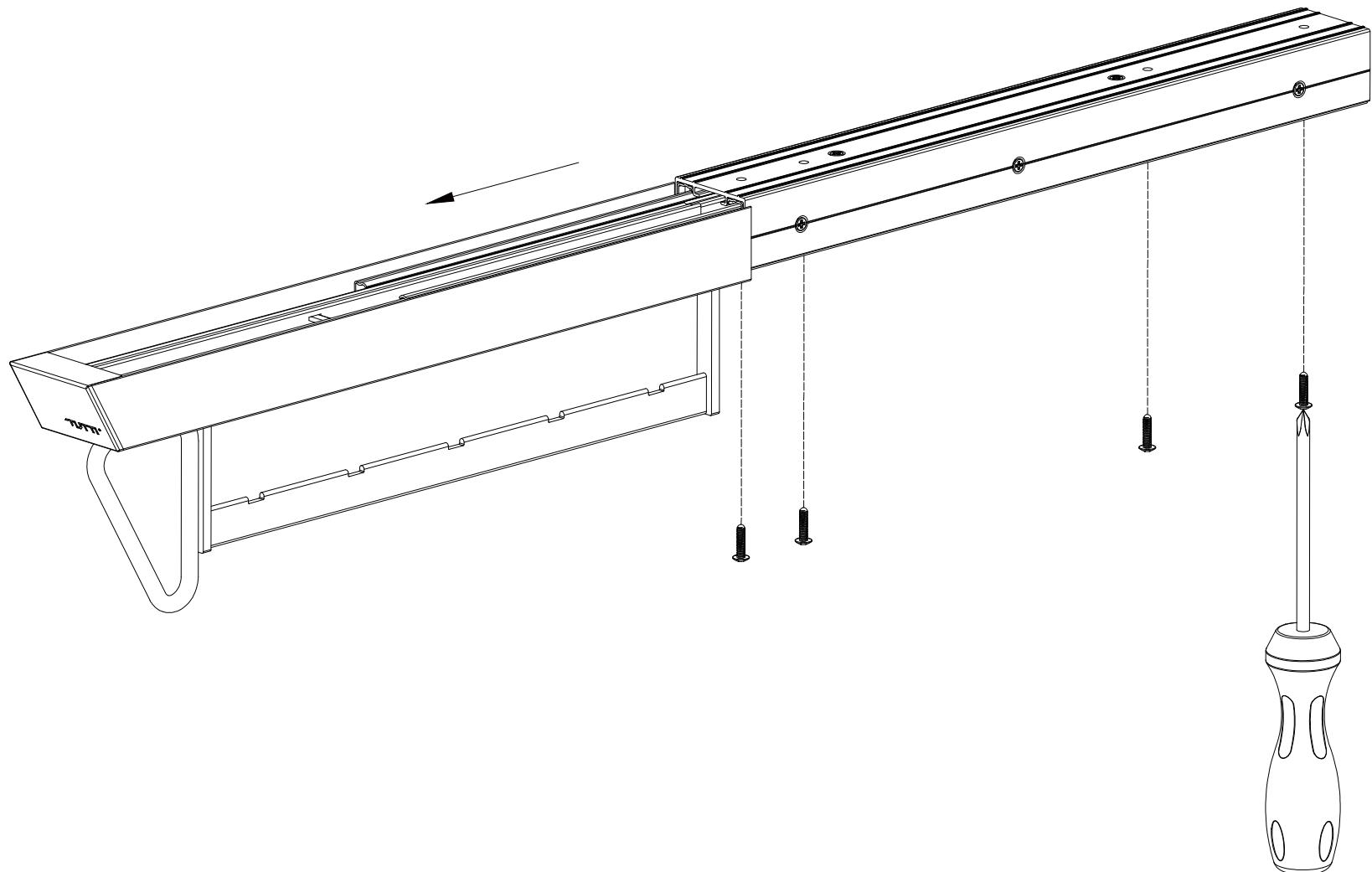
2. Подготовка монтажных отверстий для установки направляющей (на примере выдвижной штанги)
