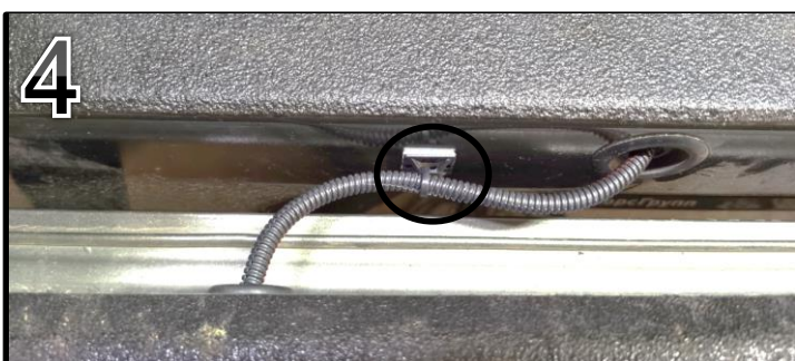
4 Зафиксировать гофру с помощью площадки под стяжку
