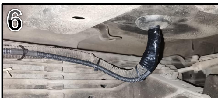
6 Протянуть гофру вдоль штатной магистрали и вывести в салон под водительским сиденьем
