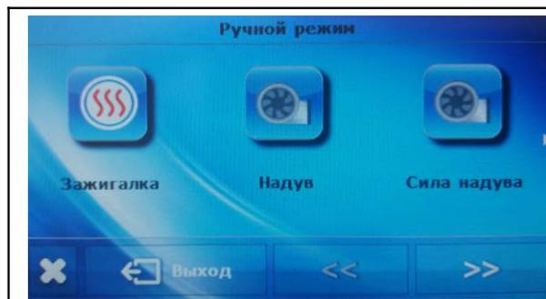
Функция используется для ручного включения каждого отдельного рабочего устройства. Функция помогает, в частности, проверять правильность подсоединения и работы Устройства розжига, Решетки, Вентилятора, Внутреннего подающего устройства, Внешнего подающего устройства, Насоса СО, Насоса ГВ, Встроенного клапана и Дополнительных насосов
