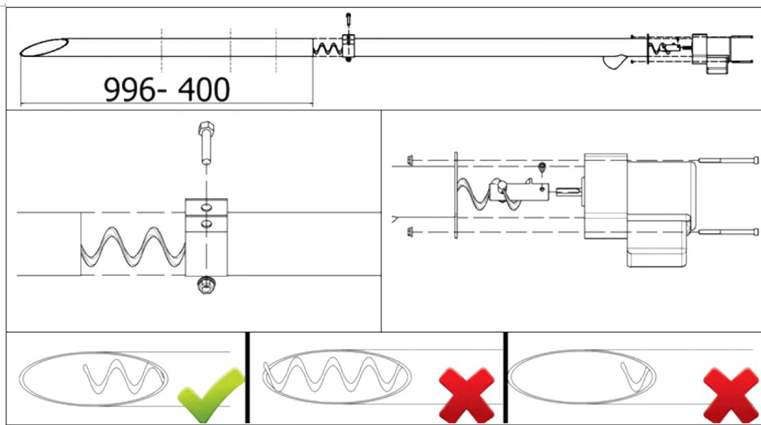
Рисунок 9 – Схема установки винтового подающего устройства в штучере бункера
