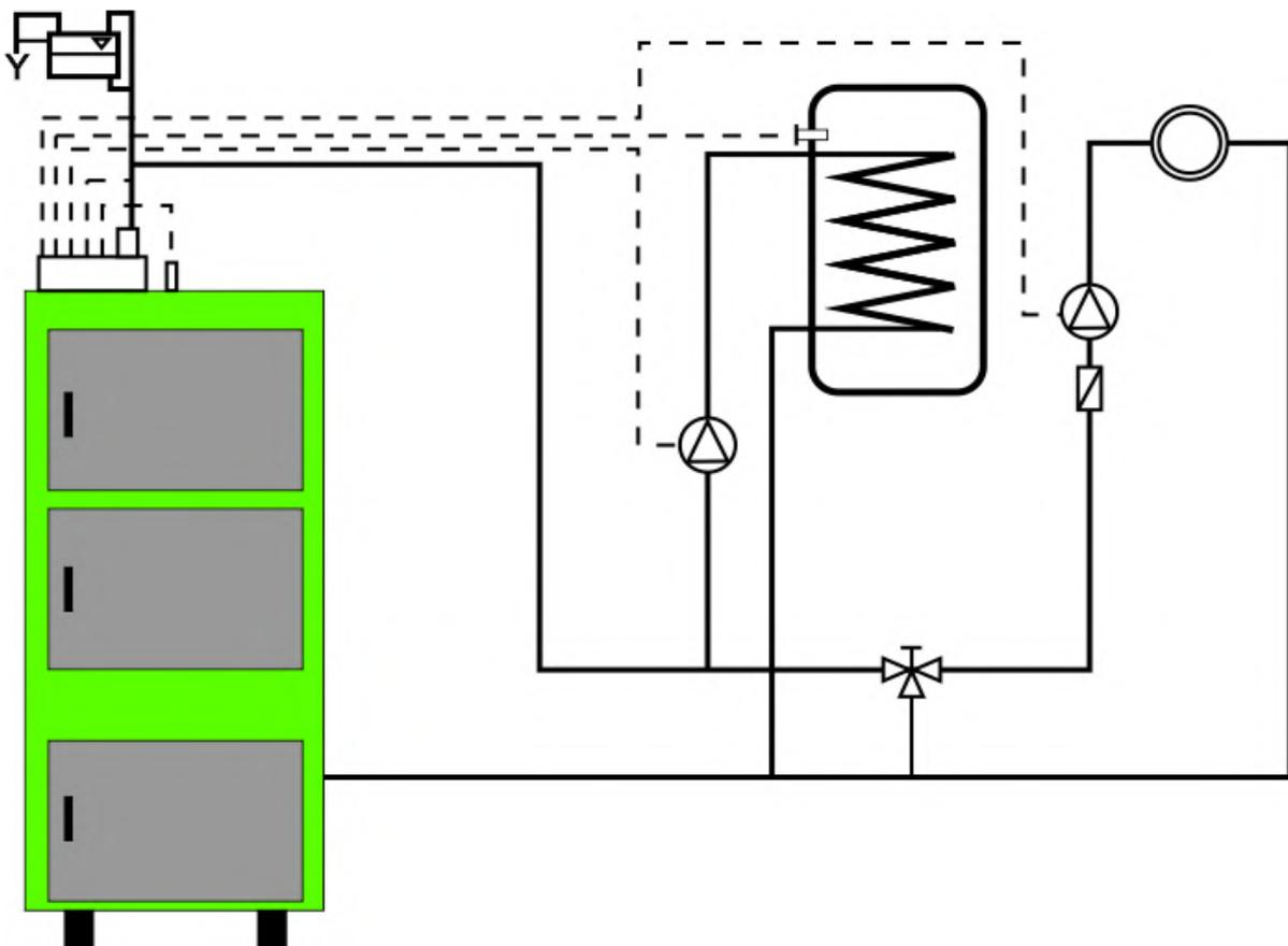
Рисунок 3 - Подключение с трехходовым клапаном и водонагревателем
