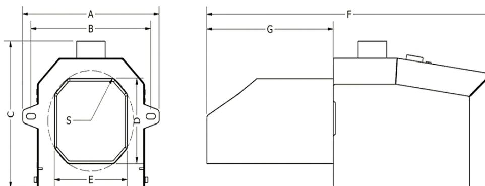
Рисунок 5 – Габаритные и присоединительные размеры Горелок Lavoro Eco 16-400
