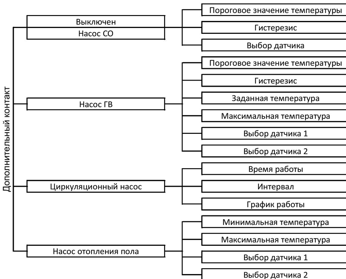
Контроллер имеет два выхода для подсоединения дополнительных насосов. После выбора типа насоса на экране отображается дополнительное меню с параметрами выбранного типа насоса.
