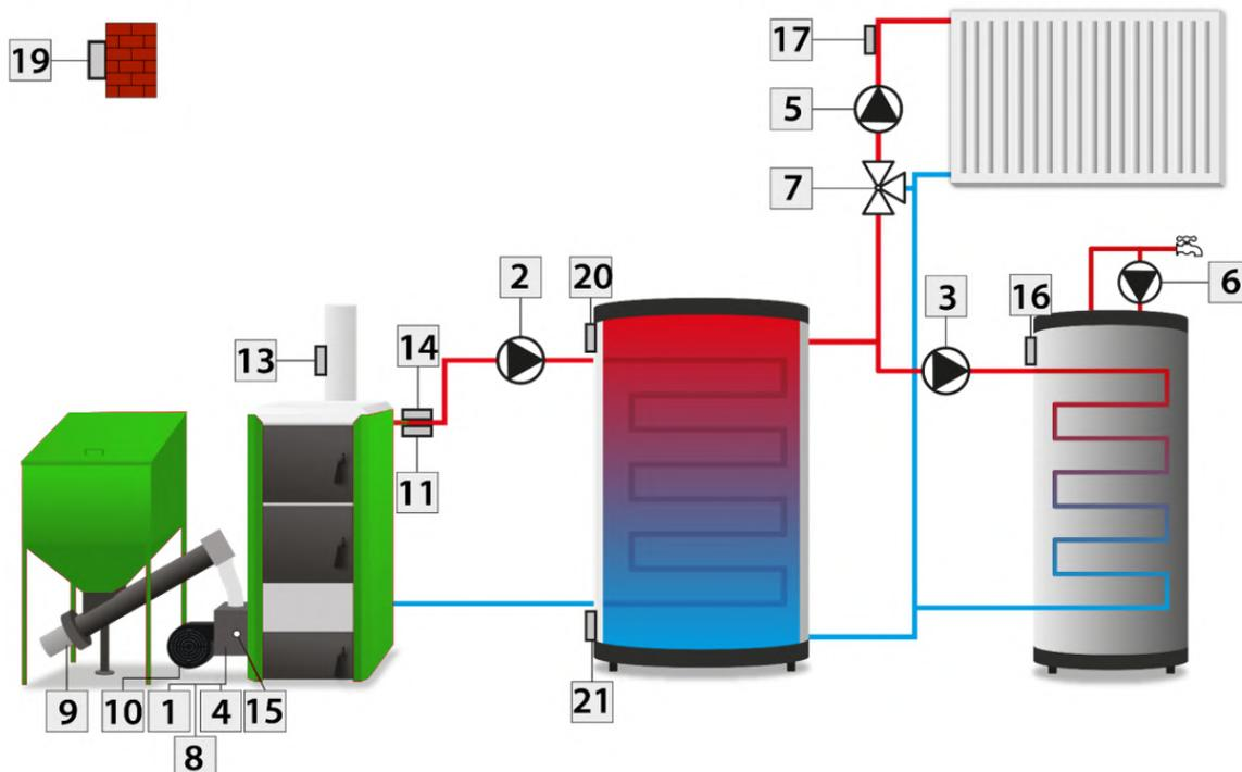
Рисунок А.3 -Примерная схема установки с тепловым буфером
