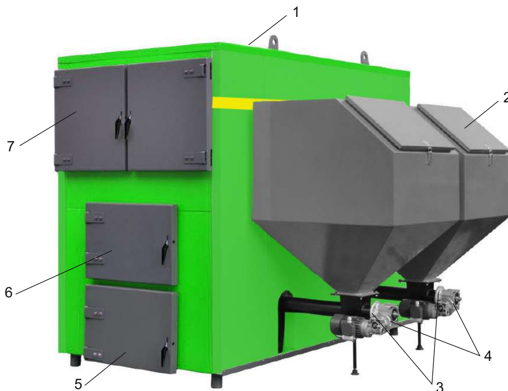
Рисунок 1 – Состав и устройство Котлов моделей LR 100-400 (общий)
