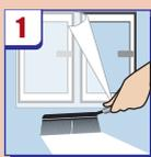
Рабочие поверхности очистить от пыли, грязи, масляных пятен и льда. Увлажнять стоит только пористые строительные материалы, такие как: кирпич, пеноблоки, гипс, бетон, дерево. Гладкие поверхности, такие как: металл, стекло и т.д. - не увлажняются. Оцинкованный металл и профлист тщательно обезжирить перед работой. Легкое увлажнение также производится поверх выпущенного POLYNORa.
