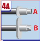
Насадку надеваем: "ушки" параллельно земле (A) - движения слева направо, "ушки" перпендикулярно земле (B) - движения снизу вверх. Нанесение на потолок: рабочее положение "ушки" - перпендикулярно земле (B), движения от себя - на себя.
