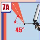
Напыление с помощью угловой насадки позволяет наносить POLYNOR® на потолок, не меняя правильного положения баллона в пространстве.
