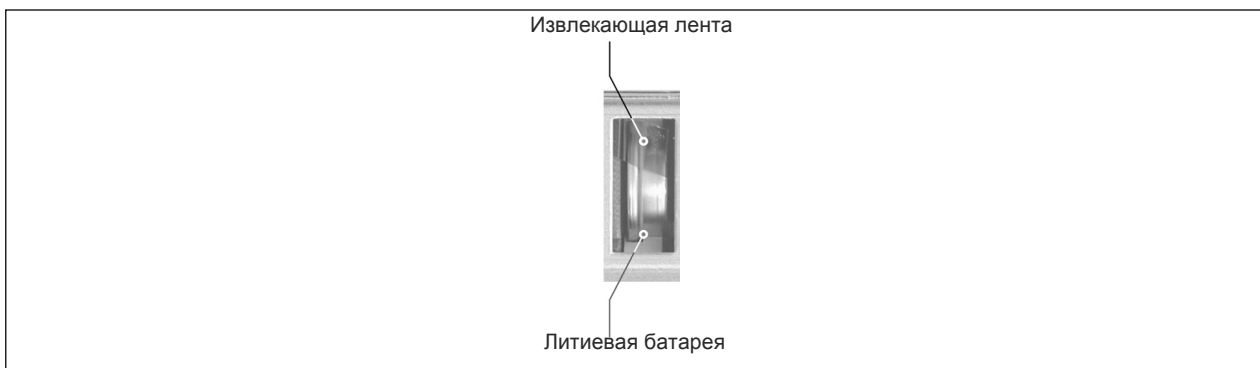
Рис. 43: извлекающую ленту нужно потянуть вправо
