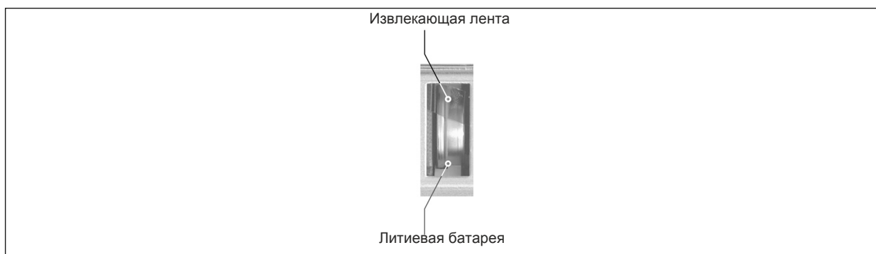
Рис. 46: извлекающую ленту нужно потянуть вправо
