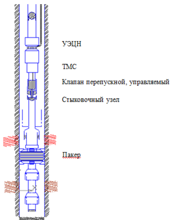
Рис. 1. Система одновременно-раздельной добычи с применением управляемого электро-клапана.
