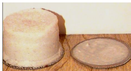
Рис. 3. Фильтрационные корки: оптимальная (справа) и неоптимальная (слева).
