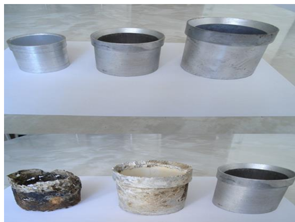
Рис. 1. Образцы протекторов ВПК до и после защиты НКТ от коррозии.
