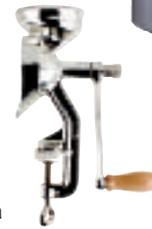
Дробилка для пробы модели Wile 66 измельчает зерно до образования однородной муки мелкого помола. Дробилка закрепляется на столе.
