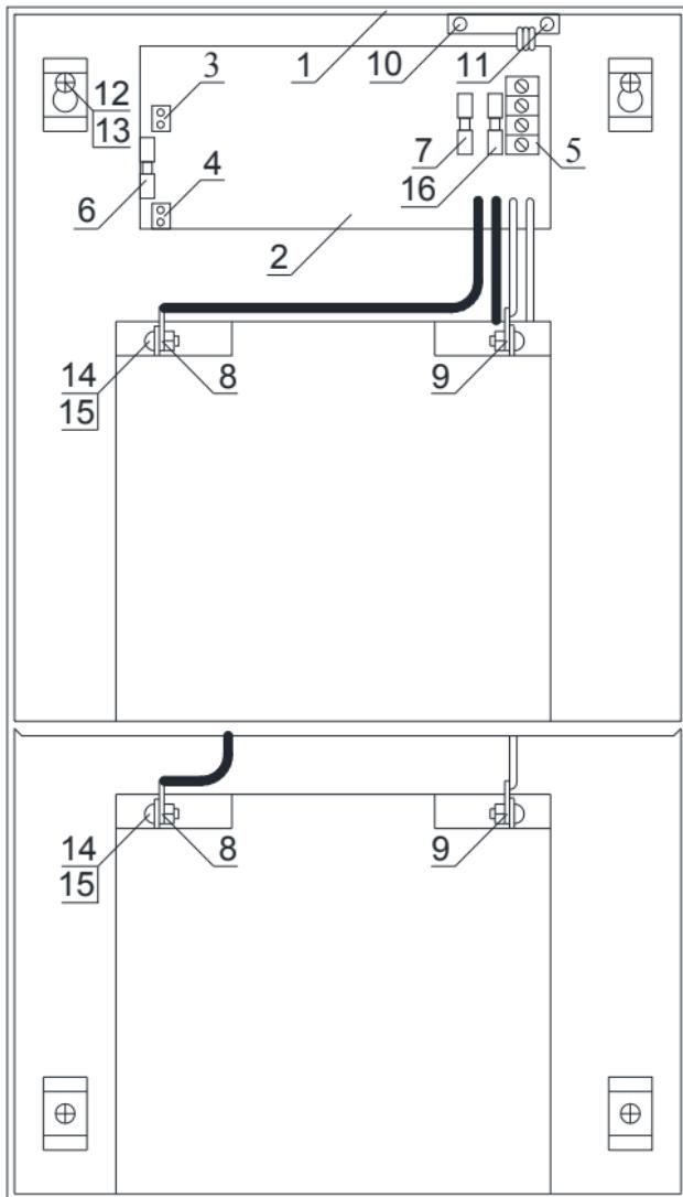
Схема монтажа источника питания ББП-100 исполнение 3
