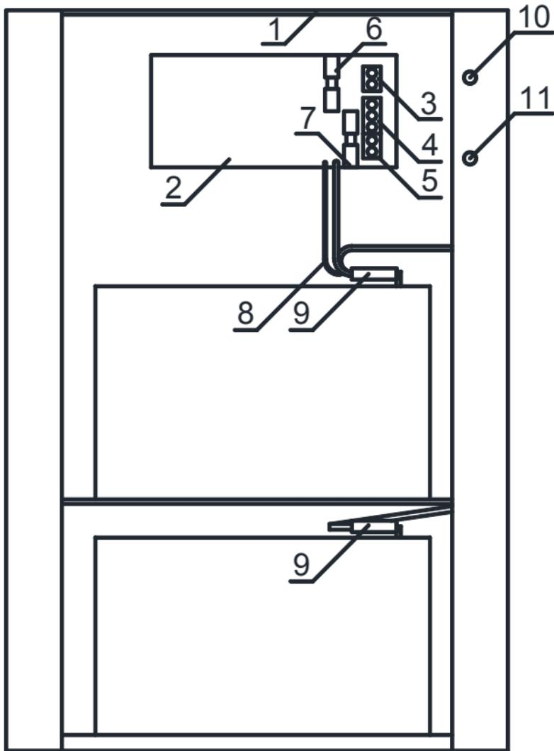
Схема монтажа источника питания
