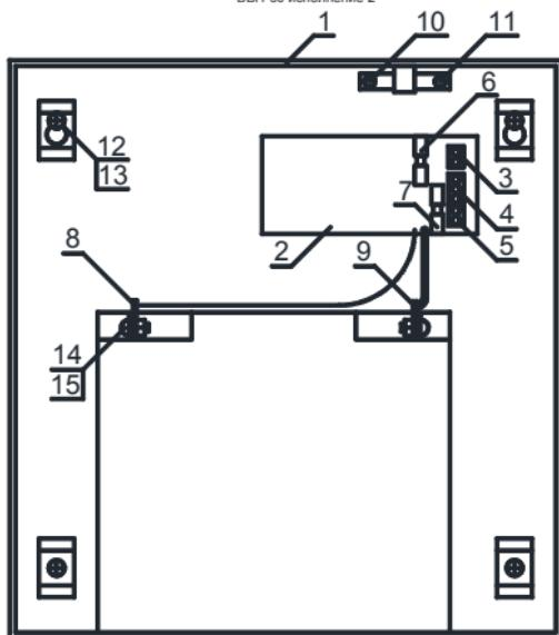
Схема монтажа источника питания ББП-30 исполнение 3
