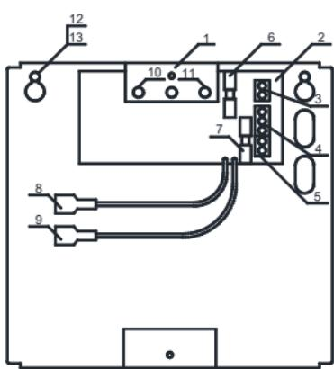
Схема монтажа источника питания
