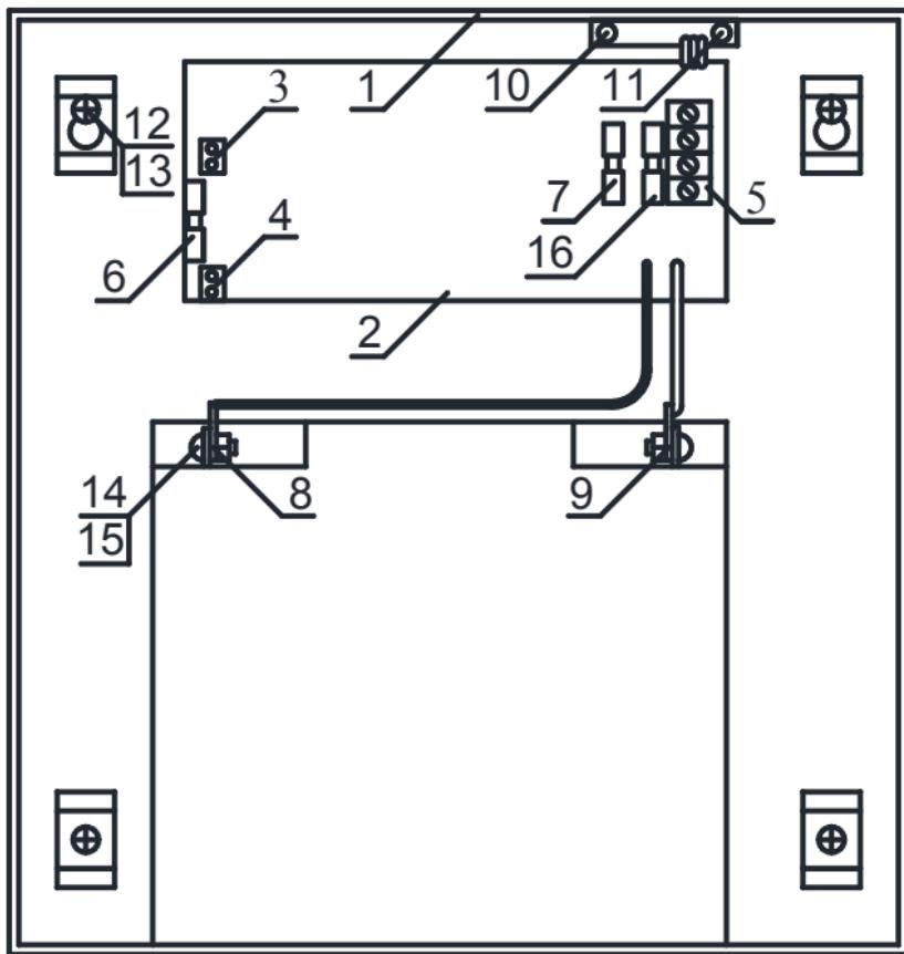
Схема монтажа источника питания ББП-100 исполнение 2
