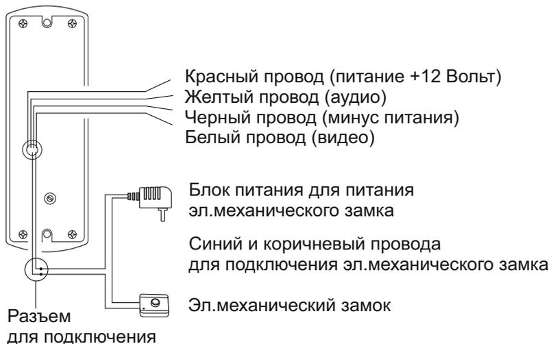
**Примечание:** панель имеет нормально открытый (N.O.) контакт. Это значит, что в исходном состоянии сухой контакт (контакт соединительный) разорван и замок в закрытом состоянии. При нажатии на кнопку «открытия замка» на видеодомофоне контакт замыкается, напряжение питания подается на замок и замок открывается.
