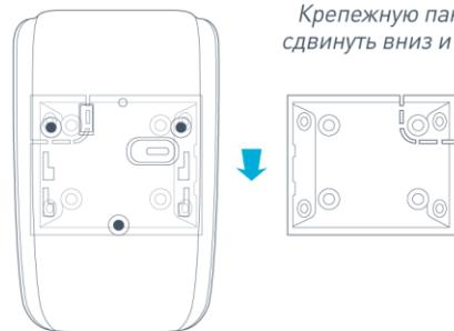
РИС. 1. Датчик движения MotionProtect и его крепежная панель
