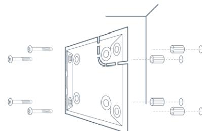
РИС. 2. Схема монтажа крепежной панели SmartBracket
