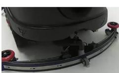
Опустить рычаг скребка, который находится справа. Вакуумная турбина включится автоматически.
