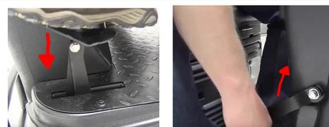
В конце работы поднять щеточную деку, скребок и отключить моторы щеток и подачу воды.
