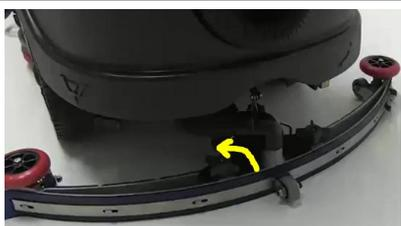
Шланг должен быть повернут в левую сторону. Снятие и установка скребка производится без использования инструмента.
