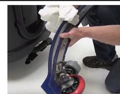
Промыть лезвия скребка водой. Проверить состояния резинок, при необходимости перевернуть.
