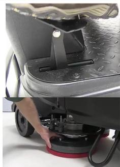
Поднять щеточную деку. Установить щетку или держатель пэда вручную.
