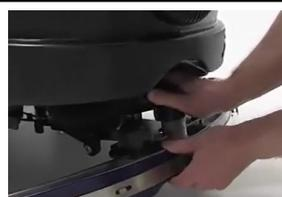
Отсоединить шланг и снять скребок с держателя.
