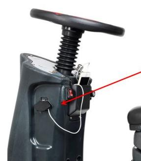
Встроенный USB разъем для зарядки мобильного телефона.
