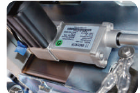
Актуатор привода щётчного узла
