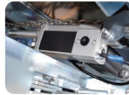
Актуатор привода водосборной балки
