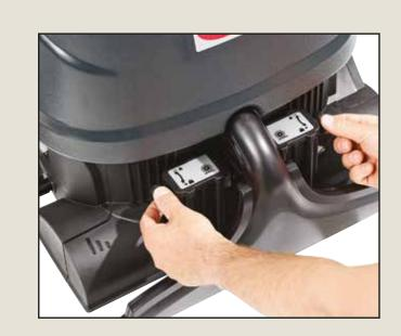
Отрегулировать давление щётки, чтобы обеспечить трение в соответствии с типом коврового покрытия.
