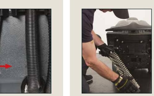
Слева извлечь и очистить щётку. Устанавливая, сначала требуется подсоединить правую часть щётки, затем вставить её левую часть. Снять и
