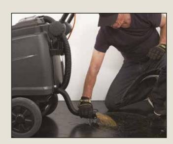
С помощью шланга опорожнить бак для отработанной жидкости.
