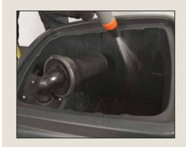
Очистить бак для отработанной жидкости.
