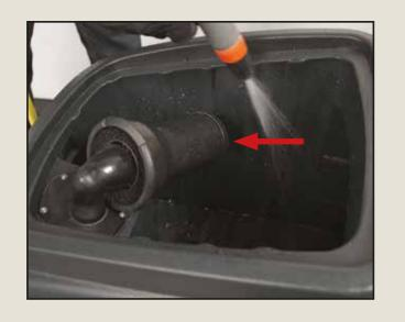
Очистить внутреннюю систему с поплавком. Очистить уплотнение крышки.=
