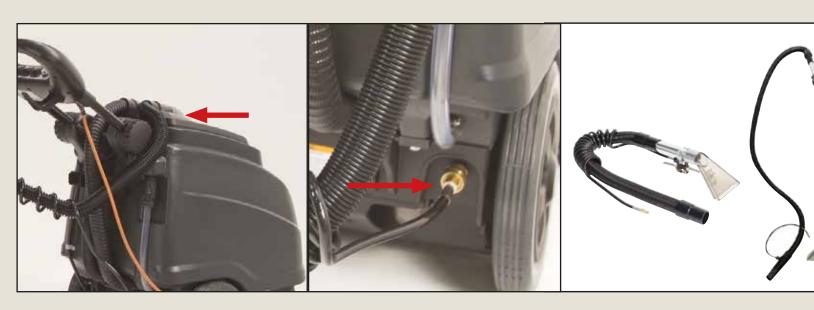
Чтобы установить аксессуары, требуется снять всасывающий шланг с крышки и подключить его к свободному соединению слева. Подключить всасывающий шланг для аксессуаров к крышке, подключить шланг для раствора к расположенному внизу справа быстроразъёмному соединению. Когда оба элемента подключены, следует убедиться, что машина припаркована на подставке, затем нажатием кнопок активировать насос и функцию всасывания. Теперь можно начать работу.
