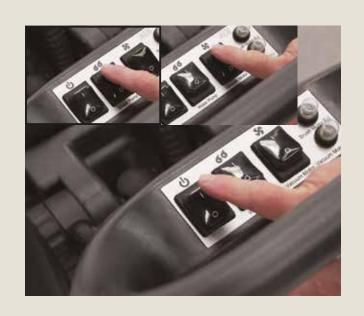
Включить пылесос и функцию всасывания, с помощью главного выключателя запустить машину.
