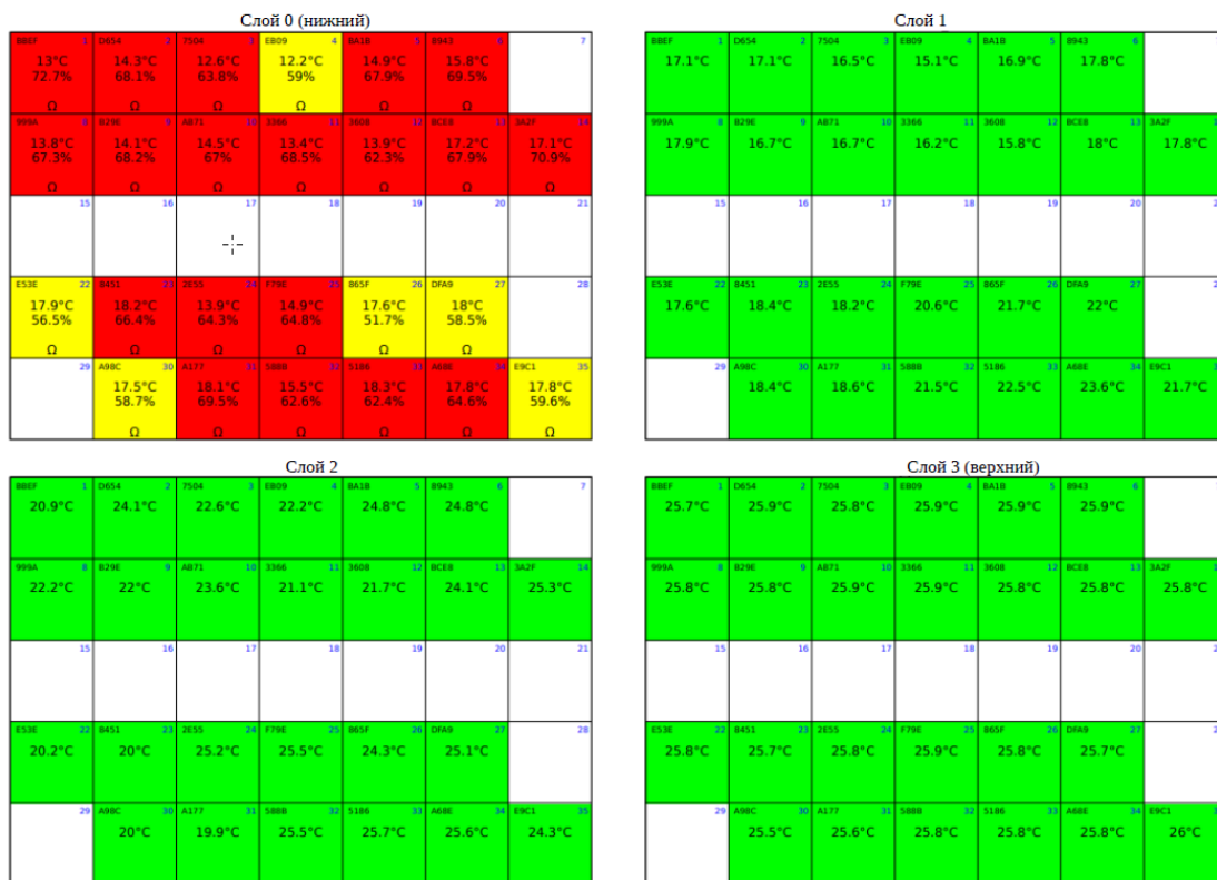
Рис. 2 Пример отчета с картами температур по слоям зерновой насыпи
