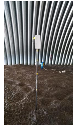
Рис. 1 Беспроводные термостанги и коллектор данных, установленные в зерноскладе
