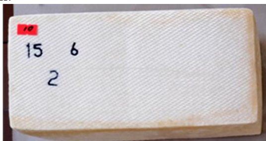
«Финишное» однослойное покрытие, нанесенное на 5-е сутки после выработки
