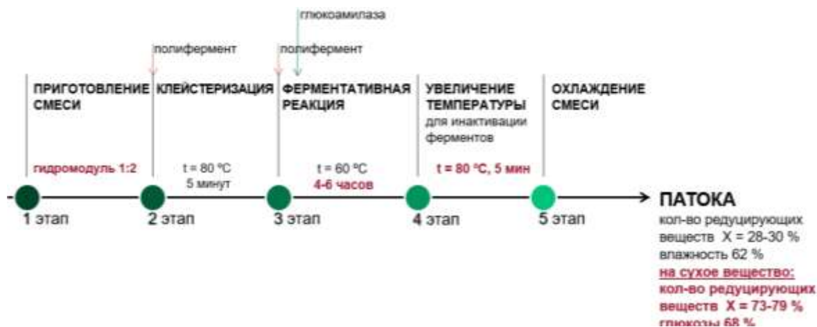
Рисунок 2 – Этапы производства зерновой патоки (кукуруза или пшеница)
