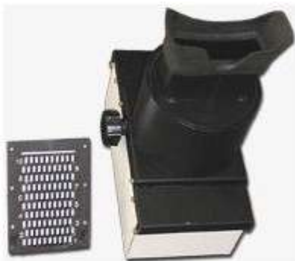
Рисунок 1. Диафаноскоп ДСЗ-2 и кассета с ячейками
