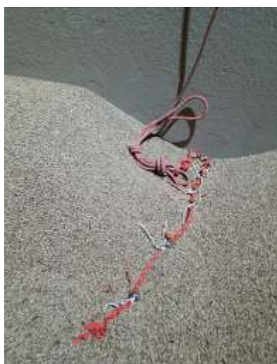
Рисунок 4 - Термогигрометры на канате внутри силоса у наружной стены, сверху засыпаются зерном
