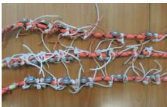
Рисунок 3 - Система регистраторов, закреплённых на трёх горизонтальных подвесках
