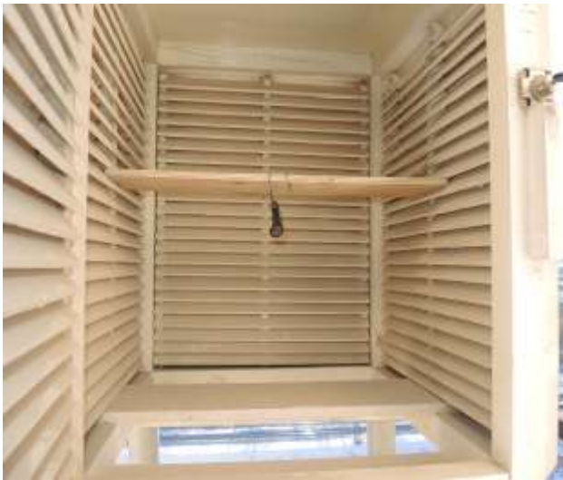
Рисунок 5 - Термогигрометр DS1923-F5 установленный в наружной климатической будке
