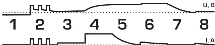
1. **Диагностический тест** - Проверка состояния аккумулятора.
