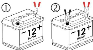
Подключите зажим ЗУ с **красной** маркировкой к (+) клемме аккумулятора.
