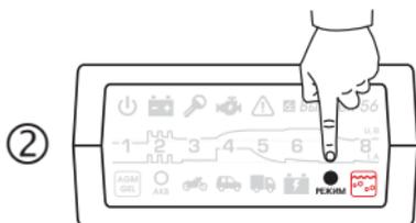
Нажатием кнопки\* **РЕЖИМ**, при необходимости, выберите дополнительный режим алгоритма заряда: "перемешивание".
