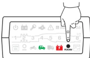
Для проверки работы вентилятора в режиме КЗ, нажатием кнопки **РЕЖИМ** активируйте режим «Форсированный заряд».
