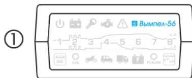
Признаком исправной АКБ (напряжение на клеммах > 6 В) является свечение индикатора названия модели ЗУ.
