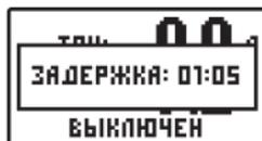
На экране отобразится время оставшееся до смены состояния (включения или выключения источника).
