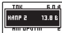
\* Верхний и нижний порог напряжения должны отличаться не менее чем на 0,5 Вольт. Если в одном из порогов невозможно установить желаемое значение, то проверьте значение в другом пороге и скорректируйте значение так, чтобы разница между порогами была больше 0,5 Вольт.
