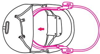
3. Проденьте часть D через отверстия в чехле сиденья и зафиксируйте оба конца в пластиковых отверстиях. Вы должны услышать щелчок. Убедитесь, что часть зафиксировалась, потянув ее обратно.
