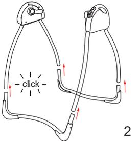
3. Встановіть частину J в пластикові кріплення на рамі. З рами повинні вилізти кріплення. Закрутіть гвинти в кріплення.
