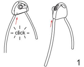
2. Прикріпіть опорні труби (I) до рами. Ви повинні почути клацання. Переконайтесь, що частини зафіксовані, потягнув їх назад. Передня опорна труба (I) повинна бути загнута всередину, а задня опорна труба загнута назовні. (Як на малюнку)
