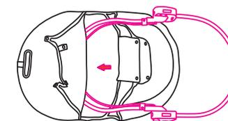
3. Протягніть частину D через отвори в чохлах сидіння та зафіксуйте обидва кінця в пластикових отворах. Ви повинні почути клацання. Переконайтесь, що частина зафіксована, потягнуйте її назад.
