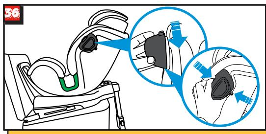
Задний элемент боковой защиты следует устанавливать со стороны, близкой к двери автомобиля.
