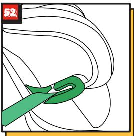
Вставьте диагональную часть ремня безопасности в направляющую ремня, чтобы она не перекручивалась (рис.52).
