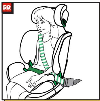
Поместите диагональную часть и поясную часть сбоку от пряжки ремня безопасности автомобиля в нижнюю направляющую ремня (рис. 50).
