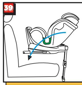
Вытащите опорную стойку. Для увеличения пространства для ног отрегулируйте бампер в наклонном положении (см.раздел 4.5, рис.11).
