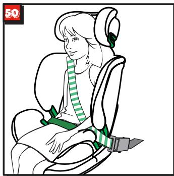
Помістіть діагональну частину та поясну частину збоку від пряжки ременя безпеки автомобіля у нижню напрямну ременя (рис.50).
