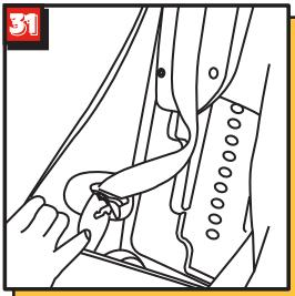
Вставьте защелки пряжек в углубления на внутренней стороне автокресла (рис.31).
