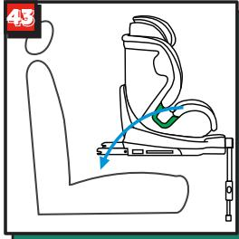
Витягніть опорну стійку, відрегулюйте бампер у вертикальне положення. Поверніть автокрісло по ходу руху (див.розділ 4.5, рис.42). Розташуйте на сидінні по ходу руху (рис.43).
