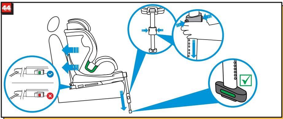
Установите ISO FIX (см.раздел 4.7). Установите опорную стойку (см.раздел 4.8) (рис. 44).
