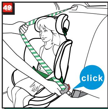
Посадіть дитину в автокрісло. Відрегулюйте підголівник на потрібну висоту (див. розділ 4.3). Витягніть ремінь безпеки автомобіля та протягніть його перед дитиною до пряжки сидіння автомобіля. Вставте язичок пряжки у пряжку сидіння автомобіля (рис.49).
