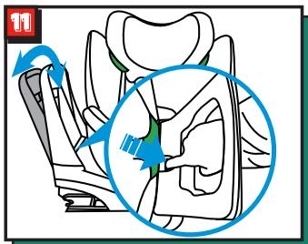
Бампер має два положення: відкинути та вертикальне. Використовуйте лише вертикальне положення, коли автокрісло встановлено по ходу руху. Поверніть автокрісло боком. Потягніть кнопку бампера вгору, потім відрегулюйте в похиле положення.
