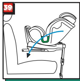
Витягніть опорну стійку. Для збільшення простору для ніг відрегулюйте бампер у похилому положенні (див.розділ 4.5, рис.11).
