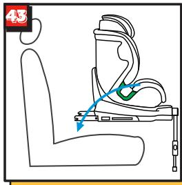
Вытащите опорную стойку, отрегулируйте бампер в вертикальное положение. Поверните автокресло по ходу движения (см.раздел 4.5, рис.42). Расположите на сиденье по ходу движения (рис.43).
