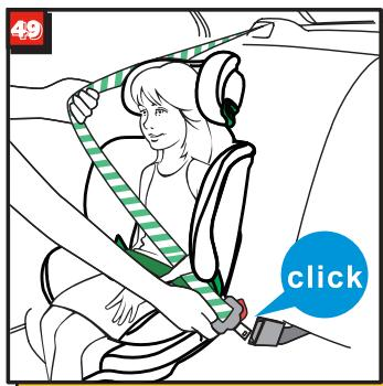
Посадите ребенка в автокресло. Отрегулируйте подголовник на нужную высоту (см.раздел 4.3). Вытяните ремень безопасности автомобиля и протяните его перед ребенком к пряжке сиденья автомобиля. Вставьте язычок пряжки в пряжку сиденья автомобиля (рис.49).
