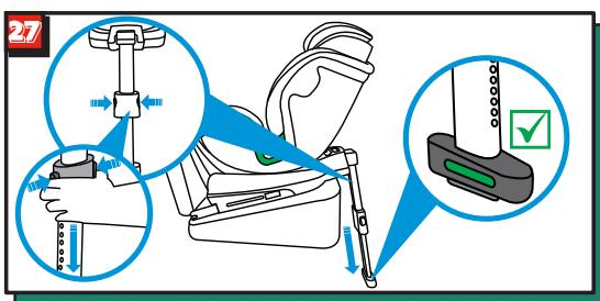
Потягніть опорну стійку з-під нижньої частини крісла до повного висування. Натисніть 2 кнопки регулювання і витягуйте опорну стійку доти, доки вона не впереться в підлогу автомобіля.
