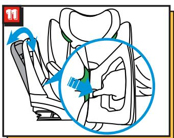
Бампер имеет два положения: откинутое и вертикальное. Используйте только вертикальное положение, когда автокресло установлено по ходу движения. Поверните автокресло боком. Потяните вверх кнопку бампера, затем отрегулируйте в наклонное положение
