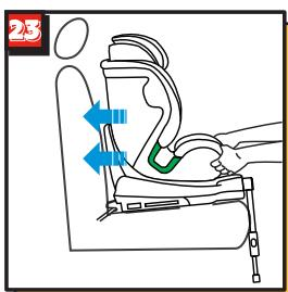
Плотно вставьте два разъема ISOFIX в направляющие до тех пор, пока разъемы ISOFIX не зафиксируются со щелчком с обеих сторон. Кнопка ISOFIX должна загореться зеленым цветом с обеих сторон (рис.21,22).
