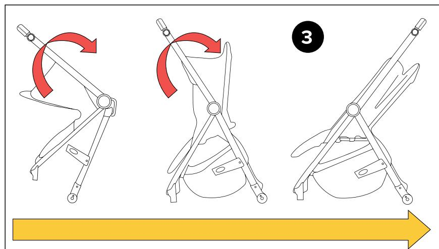
Отстегните защелку на внешней стороне коляски, как показано на рис. 2. и одновременно потяните ручку другой рукой, чтобы разложить коляску. Когда коляска раскрывается, как показано на рис. 3, вы должны услышать «щелчок» с обеих сторон коляски. Прежде чем использовать коляску, проверьте, заблокирована ли она.
