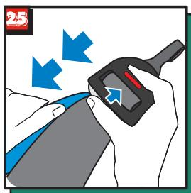
Перед використанням якірного реміння необхідно подовжити або укоротити в залежності від відстані до точки кріплення в автомобілі (рис.25). Якірний ремінь має бути туго натягнутий.
