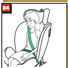
Поместите диагональную часть и поясную часть сбоку от пряжки ремня безопасности автомобиля в нижнюю направляющую ремня (рис.54).
