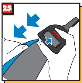
Перед использованием якорный ремень необходимо удлинить или укоротить в зависимости от расстояния до точки крепления якорного ремня в автомобиле (рис.25). Якорный ремень должен быть туто натянут.
