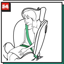
Помістіть діагональну частину та поясну частину збоку від пряжки ременя безпеки автомобіля у нижню напрямну ременя (рис.54).
