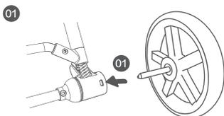
Рис. 1: Установка задних колес
