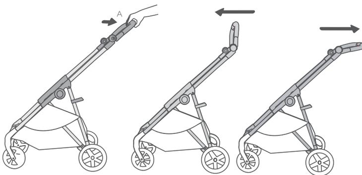
Рис. 3: Регулировка высоты ручки
