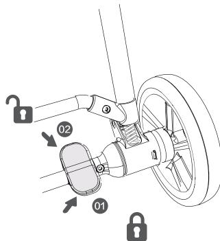
Рис. 4: Тормозная система
