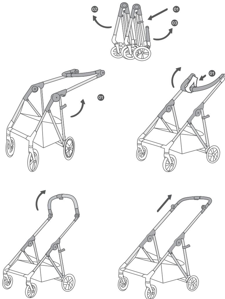
Рисунок 1: Установка рамы
