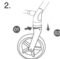
Рис. 2: Снятие передних колес
