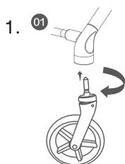
Рис. 1: Установка передних колес
