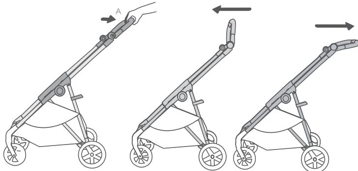
Рис. 3: Регулировка высоты ручки
