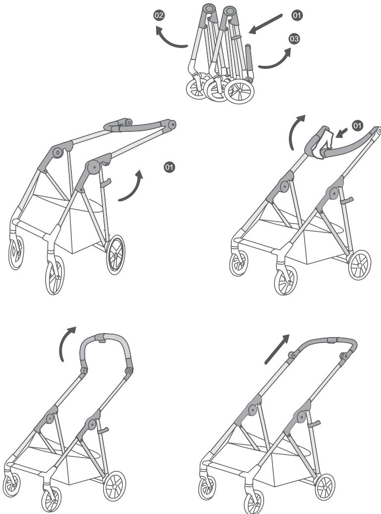
Рисунок 1: Установка рамы
