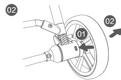
Рис. 2: Снятие задних колес
