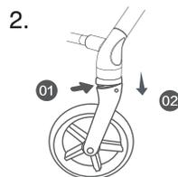
Рис. 2: Снятие передних колес
