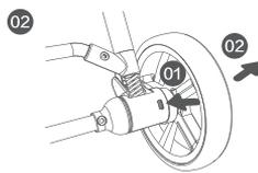
Рис. 2: Снятие задних колес
