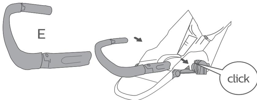
Рис. 7: Установка бампера безопасности
