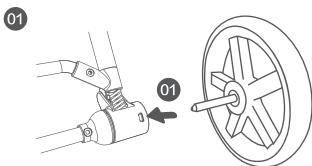
Рис. 1: Установка задних колес
