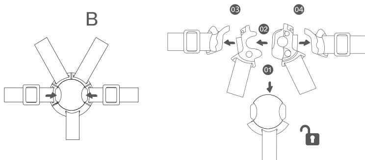
Рис. 12-Б: Снятие ремня безопасности
