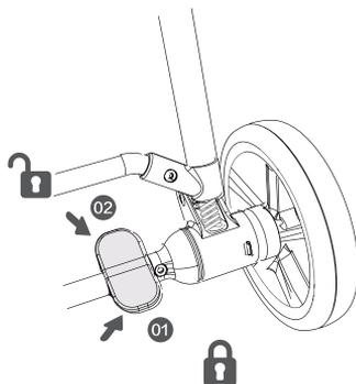
Рис. 4: Тормозная система
