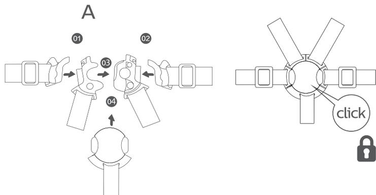
Рисунок 12-А. Установка ремня безопасности -
