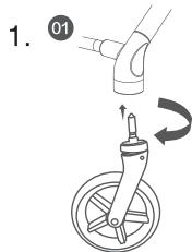
Рис. 1: Установка передних колес
