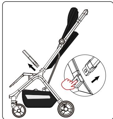
10. Бампер можно поворачивать на 360 градусов, если вытащить только одну сторону бампера.
