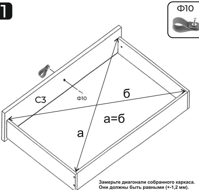
Замерьте диагонали собранного каркаса. Они должны быть равными (+1,2 мм). Только после этого можете закрепить заднюю стенку ЛДВП при помощи гвоздей!
