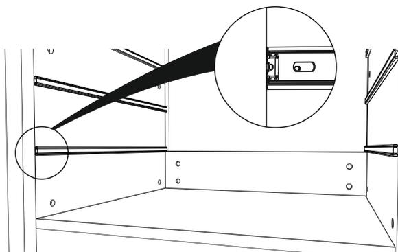
Установите ящики путем совмещения направляющих. Широкую часть направляющих выдвинуть до упора. Установить рельсы с обеих сторон равномерно и задвинуть ящик до конца. При правильном креплении ящика должен прозвучать щелчок.
