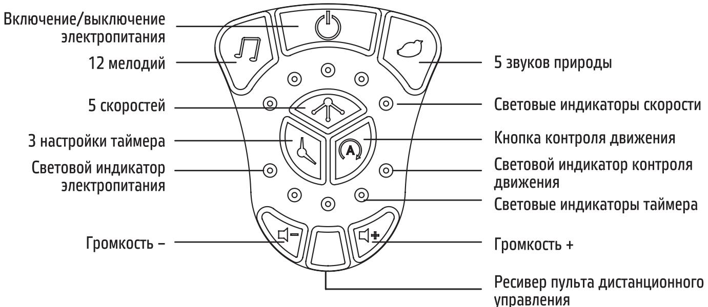
**Включение/выключение электропитания:** нажмите кнопку, электропитание шезлонга включится и световой индикатор электропитания станет красным.
