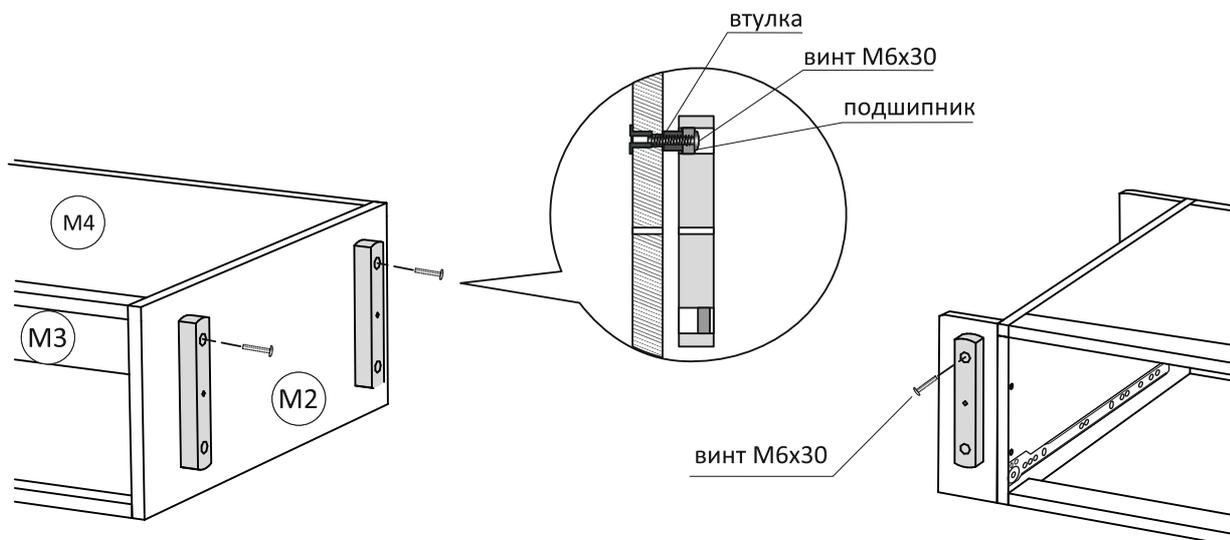
4.2 Установить поперечный маятники на горизонтальный брусок (7) с помощью винтов M6 и втулок.
