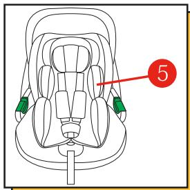
Вкладыш для новорожденного (5) можно снять, когда ребенок достигнет 61 см (около 3 месяцев), чтобы освободить ребенку больше места. Чтобы снять вкладыш для новорожденного (5), откройте ремни и снимите наплечники. Затем снимите вкладыш для новорожденного и наденьте наплечники обратно на плечевые ремни.
