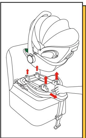
Потяните кнопку разблокировки, чтобы освободить автокресло, и поднимите ее за ручку. Базовый индикатор станет КРАСНЫМ.
