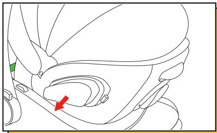
**ПРИМЕЧАНИЕ!** Убедитесь, что выдвижная часть зафиксировалась на месте со звуковым «ЩЕЛЧКОМ». Защиту можно полностью сложить в исходное положение, если выполнить действия в обратном порядке (сначала нажать 25, затем 24).
