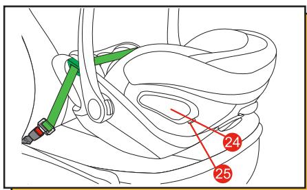
«Линейная защита от бокового удара» встроена в автокресло. Эта система повышает безопасность вашего ребенка в случае бокового столкновения. Для достижения наилучшего защитного эффекта активируйте защиту (24) в сторону двери автомобиля, ближайшей к автокреслу. Чтобы активировать, нажмите на отмеченную область (25). Если невозможно полностью высвободить защиту при закрытой двери автомобиля, вы также можете использовать детское автокресло с неактивной защитой.
