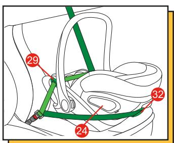
**! ПРЕДУПРЕЖДЕНИЕ!** Детское автокресло не предназначено для использования с двухточечным или поясным ремнем безопасности автомобиля. Пристегивание двухточечным ремнем безопасности автомобиля может привести к серьезным травмам ребенка в случае аварии.
