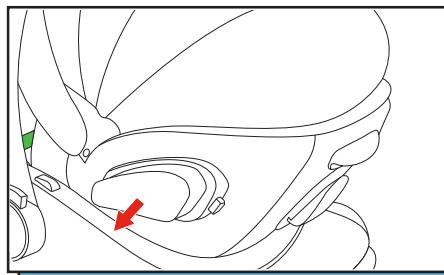
**UWAGA:** Upewnij się, że wysuwana część blokuje się na miejscu ze stycznym "kliknięciem".
