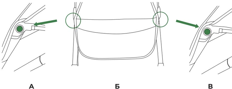
Для регулировки опоры для ног, нажмите одновременно на боковые кнопки, изображенные на рисунках А, Б и В, и потяните вверх или вниз. Опора для ног может быть зафиксирована в 2 положениях.
