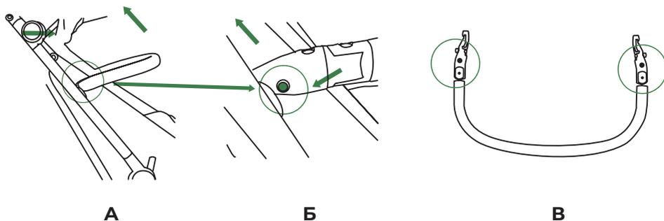
1. Одновременно нажмите на кнопки, как показано на рисунках А, Б и В и потяните вверх, чтобы снять бампер.
