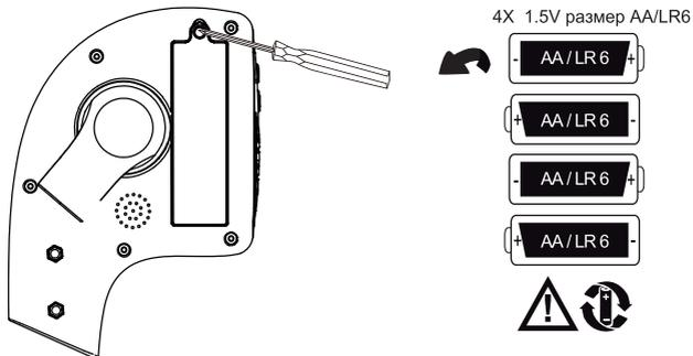
\*Открутите крышку отсека для батареек отверткой (не включена в комплект) и снимите крышку
