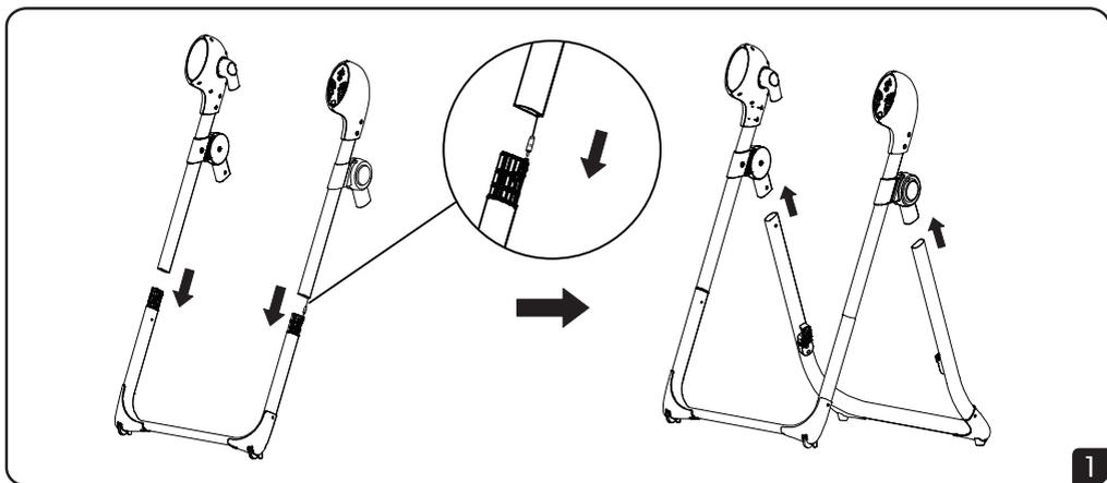
2. Сиденье: закрепите соответствующие трубки сидения ставив их в верхнюю приводную часть до щелчка.
