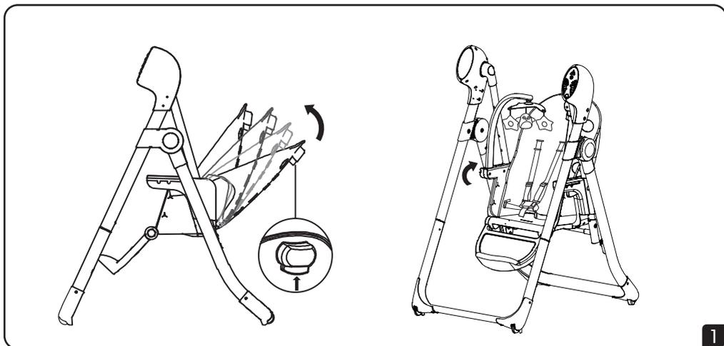
2. Подножка имеет три положения. Нажмите кнопку регулировки А, поднимите или опустите подножку. Подножка также имеет два варианта по длине. Нажмите кнопку В, задвиньте или выдвиньте подножку.
