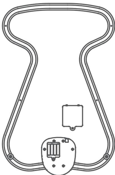
1) Открутите винты крышки отсека для батареек и снимите крышку.
