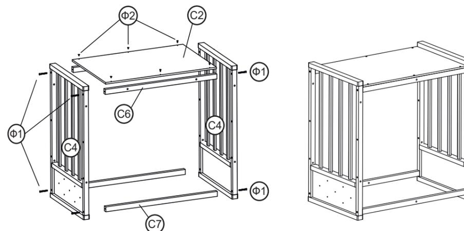
Соединяем центральные решетки C4 с брусками для пеленального стола C6, при помощи евровинтов Ф1 (обратите внимание, что отверстия на продольных краях должны быть расположены горизонтально). Такую же операцию производим с брусками для пеленального стола C7. Далее сверху закрепляем ложе C2 саморезами Ф2.
