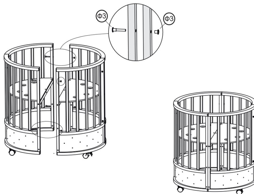
Соединяем две секции состоящие из решеток угловых С3, стяжками Ф3 (винт и гайка) сверху и снизу.
