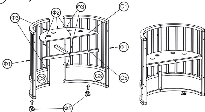
1. Соединяем две решетки угловые С3, стяжками Ф3 (винт и гайка) сверху и снизу. Аналогичным образом, необходимо соединить оставшуюся пару угловых решеток С3. Особое внимание при сборке уделите выравниванию краев скрепляемых угловых решеток С3.
