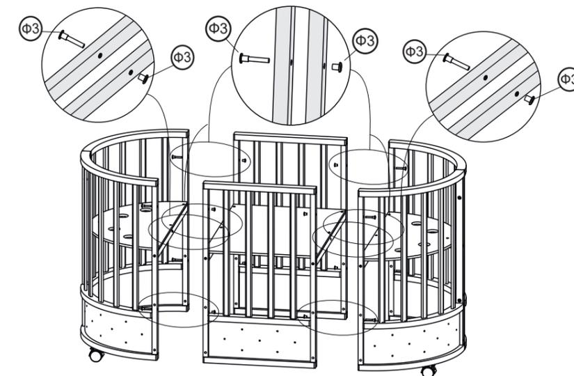
Соединяем две секции состоящие из решеток угловых C3, с центральными решетками, при помощи стяжек Ф3 (винт и гайка) сверху и снизу. Так же необходимо, для большей жесткости, соединить при помощи стяжек Ф3 бруски поддержки ложа и бруски верхние пеленального стола.
