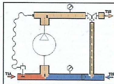
Теплоноситель первичного контура T1A поступает в насосно-смесительный узел через термостатический клапан 1. Степень открытия клапана автоматически регулируется в зависимости от выбранной настройки и температуры теплоносителя на подаче к коллектору системы отопления. Циркуляционный насос обеспечивает циркуляцию теплоносителя во вторичном контуре, при
