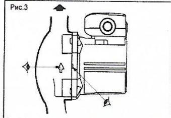
Установите обратный клапан на выходе, задвижки на входе и выходе, чтобы без проблем демонтировать насос в случае необходимости.
