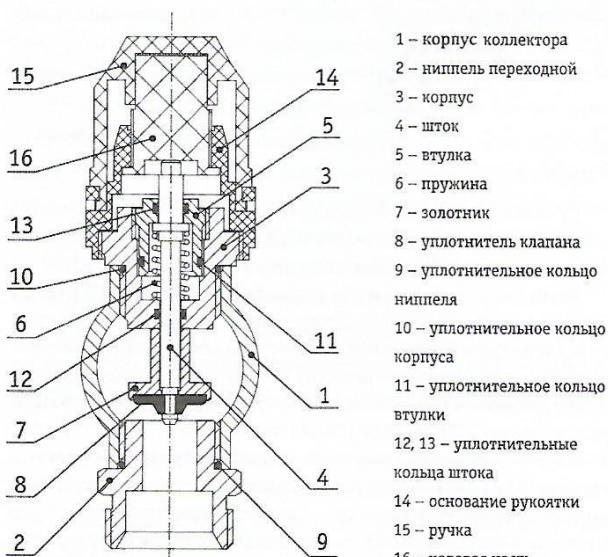
Запорный клапан устанавливается в боковые отводы обратного коллектора (1). Он состоит из корпуса (3), штока (4), втулки (5), пружины (6), золотника (7) и рукоятки.
