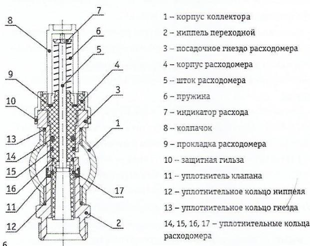
Ручной регулировочный клапан с расходомером устанавливается в боковые отводы подающего коллектора (1). Он состоит из посадочного гнезда (3) и самого расходомера.
