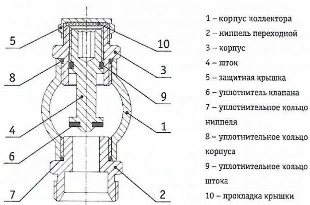
Ручной настроечный клапан без расходомера устанавливается в боковые отводы подающего коллектора (1). Он состоит из корпуса (3), настроечного штока (4) и защитной крышки (5).
