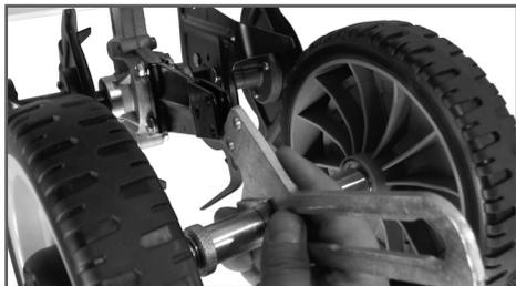
Рис. 6 Установка кронштейна колес
