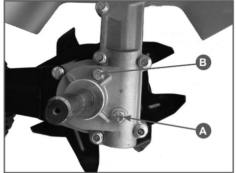
Рис. 23 Обслуживание редуктора
