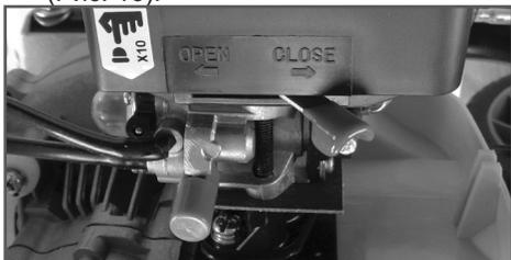
Рис. 16 Воздушная заслонка карбюратора закрыта
