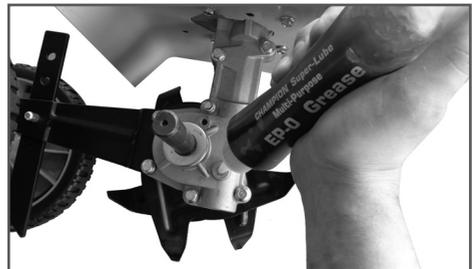
Рис. 24 Добавление смазки в корпус редуктора
