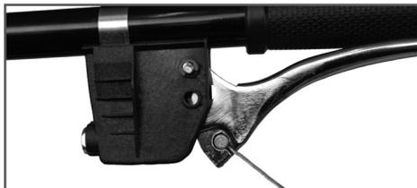
Рис. 9 Установка наконечника троса газа
