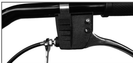
Рис. 10 Установка регулировочной муфты троса газа
