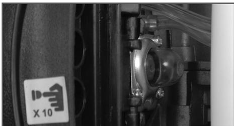
Рис. 15 Ручной топливный насос
