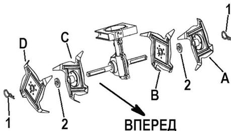
Рис. 4 Установка фрез
