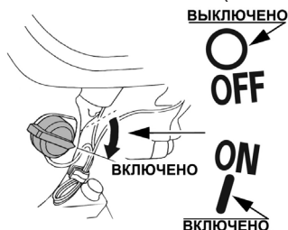
Рис. 14 Выключатель зажигания в положении «Включено»
