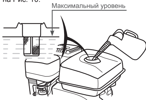
Рис. 10 Максимальный уровень топлива в топливном баке
