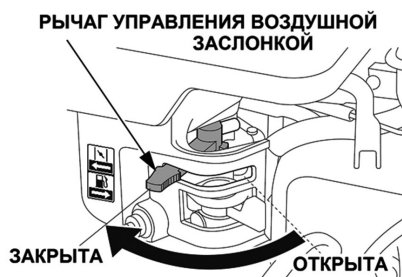
Рис. 12 Воздушная заслонка закрыта
