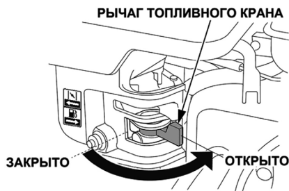
Рис. 11 Топливный кран открыт
