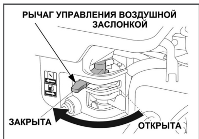
Рис. 24 Рычаг управления воздушной заслонкой
