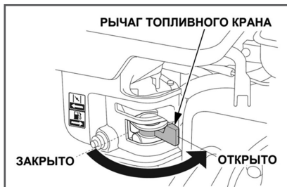
Рис. 25 Рычаг топливного крана
