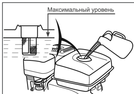
Рис. 22 Максимальный уровень топлива в топливном баке
