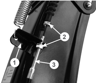
Рис. 21 Установка оболочки троса управления дефлектором жёлоба
